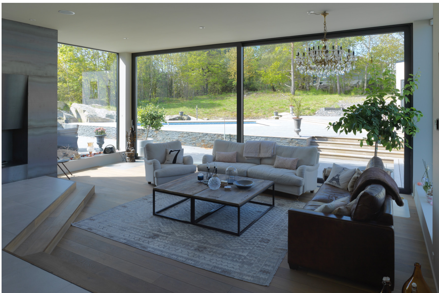
En av marknadens största lyftskjuddörr, Sapa 2160, med mått 7500 x 3500 mm (!) öppnar upp mot baksidan
